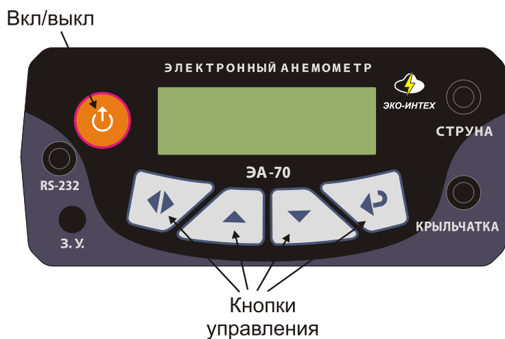
Рис. 5.1. Электронный анемометр ЭА-70 (0) (передняя панель)
