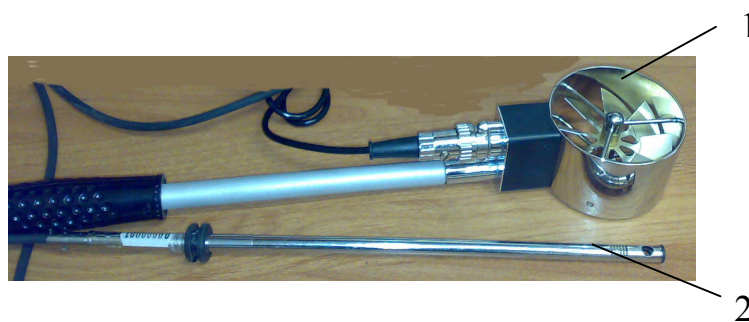
Рис. 5.2. Зонды к ЭА-70: 1 – зонд-крыльчатка, 2 – «обогреваемая струна».
